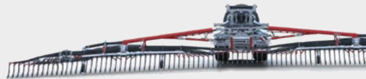
**Situation 2:** Der Fasswagen befindet sich am Rand eines Gefälles. Die Stellung des linken Seitenarms ist abschüssig, der rechte ist in waagerechter Position. Der integrierte Höhen- und Pendelausgleich des linken Auslegers gleicht die Unebenheit aus. Somit folgen alle Kufen durchgängig der Bodenkontur.
