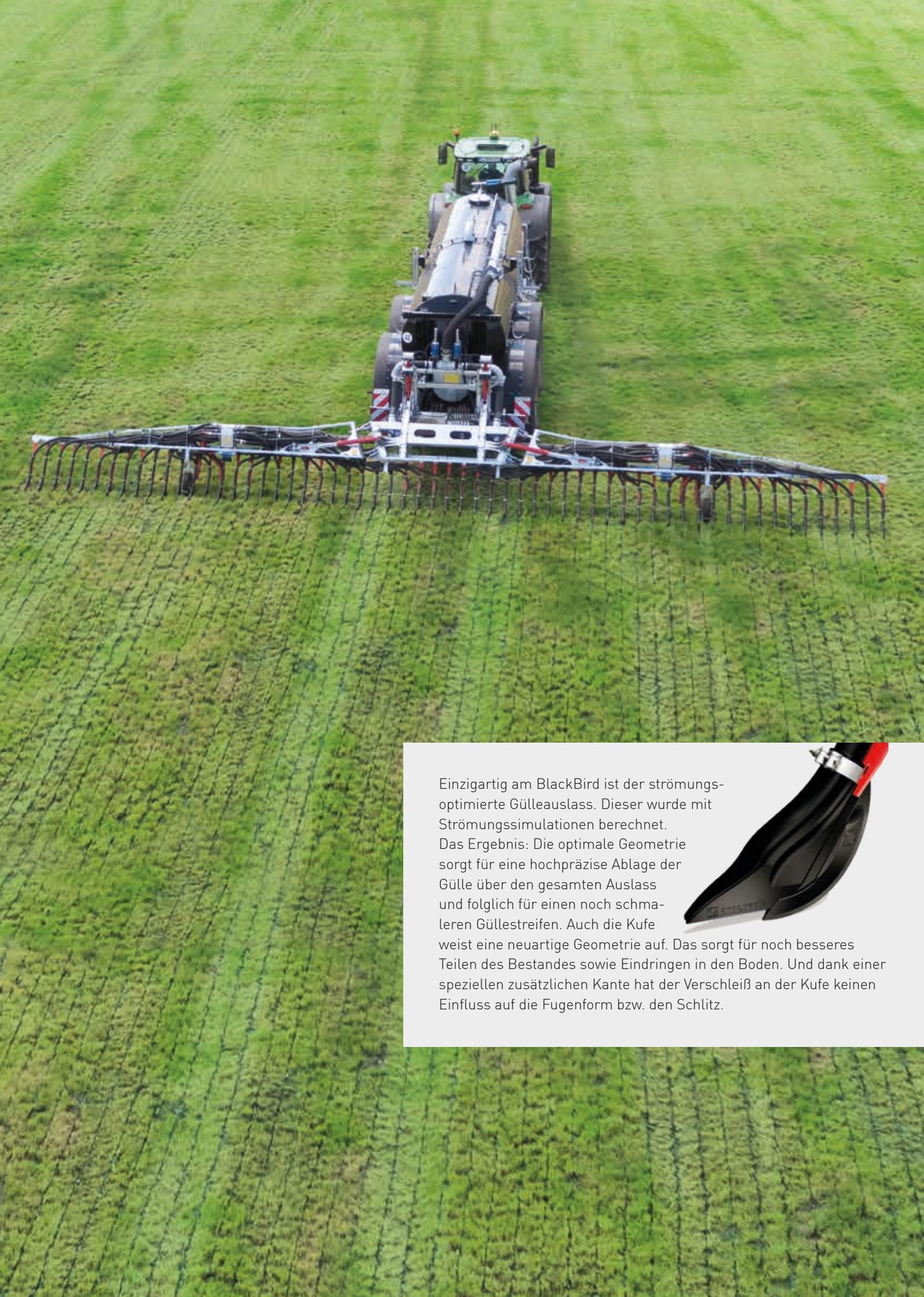
Einzigartig am BlackBird ist der strömungs-optimierte Gülleauslass. Dieser wurde mit Strömungssimulationen berechnet.
