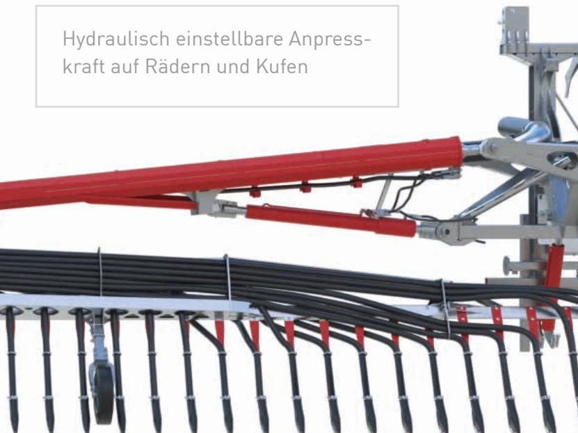
Flexibles Teilbreitenmanagement zur Realisierung unterschiedlicher Arbeitsbreiten mit einem Gestänge ohne Überstand des Rahmens
