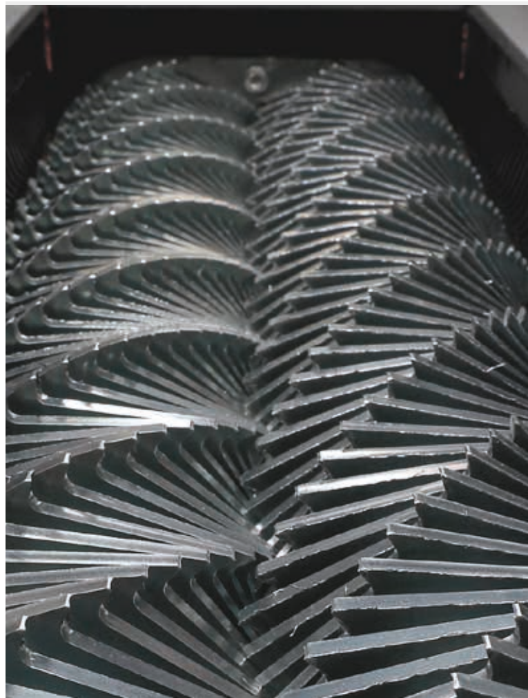
Die monolithischen One-Piece Ripper-Rotoren sind extrem biegesteif und besonders einfach in der Wartung
